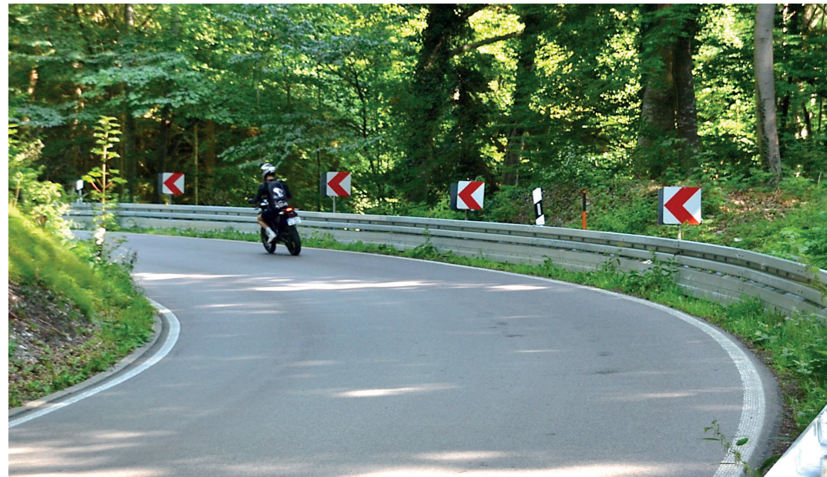
Abb. 27 Beispiel einer schlecht einsehbaren Kurve mit aufgelösten Richtungstafeln, Schutzplanke und Unterfahrschutz
